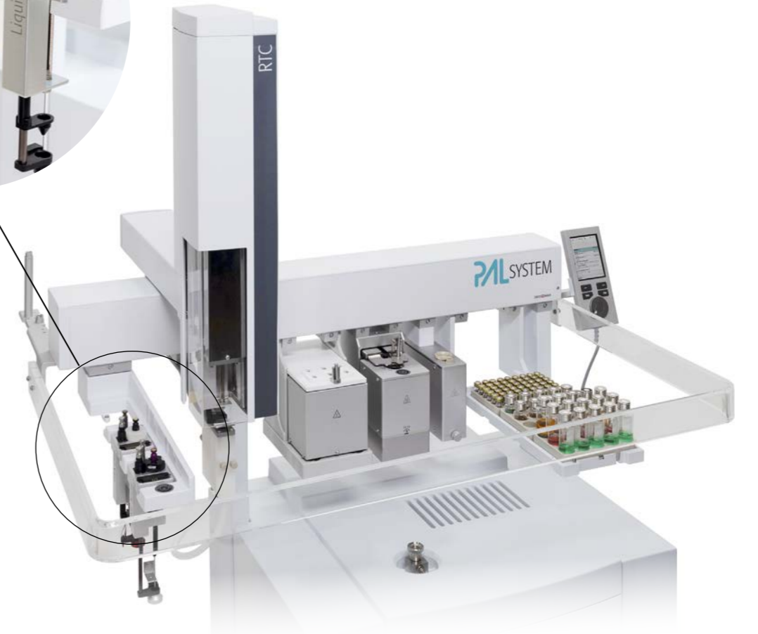
标准版PAL RTC 安装在GC & GC/MS之上
